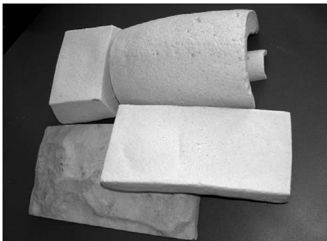
Рис. 4. Фотография блоков пеностекла, полученных без использования жаропрочных форм и без дополнительной механической обработки
