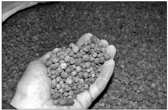
Рис. 2. Внешний вид пеностеклянного гравия
